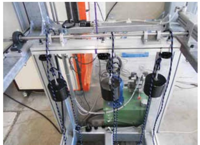
*Attrezzatura per test affaticamento cordini.*
