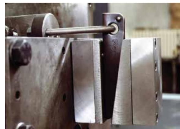
Apparecchiatura per prove rottura chiodi.
