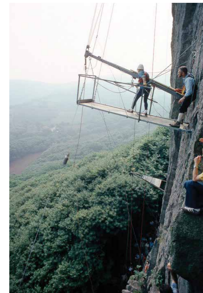
Rocca Pendice, Carlo Zanantoni in una prova di assicurazione con nodo mezzo barcaiole (foto Lorenzo Trento).
